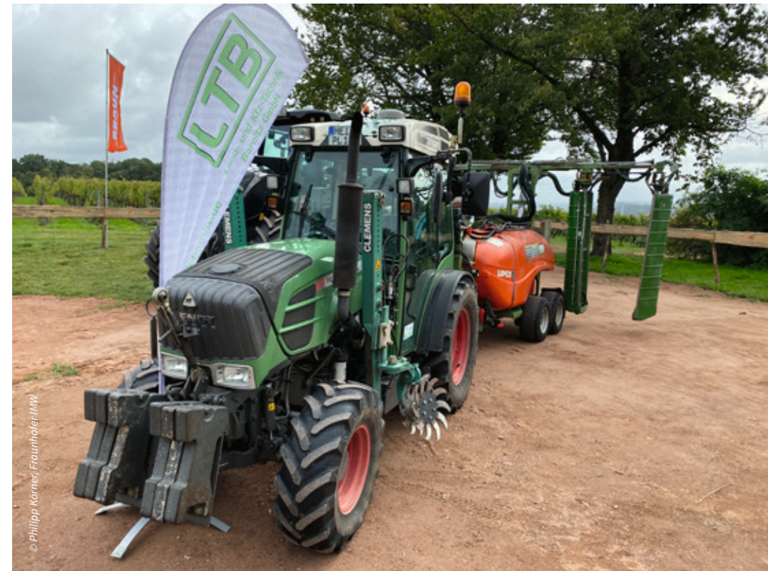
Abbildung 7: Ein typischer Weinbauschlepper mit einer Recyclingspritze im Direktzug.
