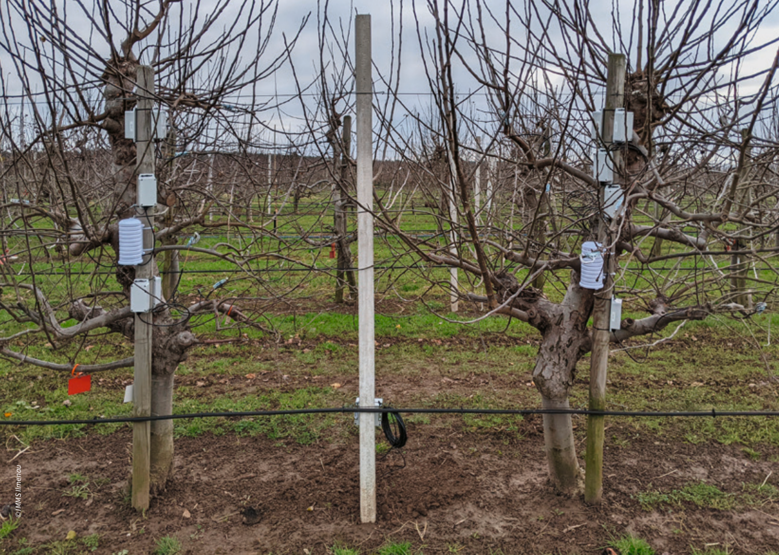
Abbildung 2: Mikroklima-, Bodenfeuchte- und dendrometrische (Knospenwachstum) Sensorik in einer Obstbau Versuchsanlage.
